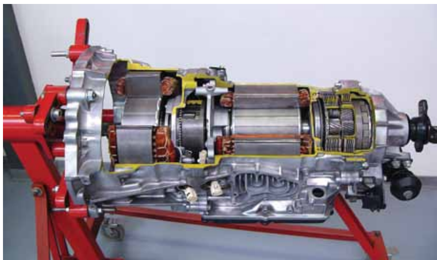
Przekrój hybrydowego zespołu napędowego
