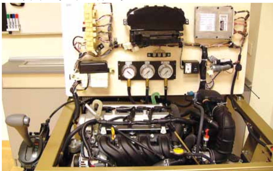
Symulator układu sterowania silnikiem i automatyczną skrzynią biegów. Poniżej: ćwiczenie podczas finału Konkursu Mechanik Toyoty 2011
