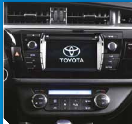
SYSTEM MULTIMEDIALNY Toyota Touch 2 integruje obsługę m.in. kamery cofania, telefonu, odtwarzacza muzycznego i nawigacji satelitarnej.
