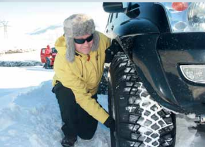
Podstawowe działanie przed wjazdem w śnieżny teren: zmniejszenie ciśnienia w oponach.
